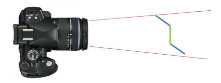
Aufbauten ohne ausreichend grosse und nicht plan zur Sensorebene aufgestellte Fokusebene sind weniger brauchbar, da der AF-Sensor sich nicht exakt an eine exakte Entfernung halten kann.
